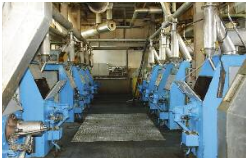
Aus dem Raps wird in Vorpressen (rechts) und Nachpressen (links) das Öl gewonnen. Täglich verarbeitet die Florin AG rund 250 t Raps.
