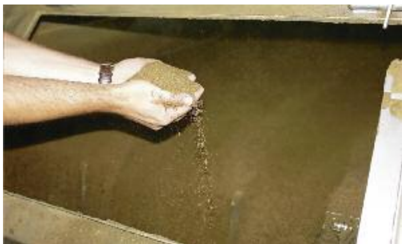
Rapskuchen entsteht als Nebenprodukt der Ölgewinnung. Dieser wird getrocknet und als eiweissreiches Futtermittel eingesetzt.
